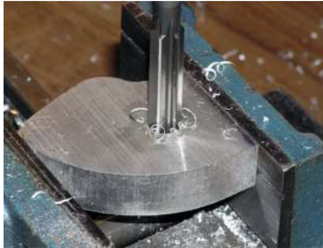
Merimer pada mesin frais
