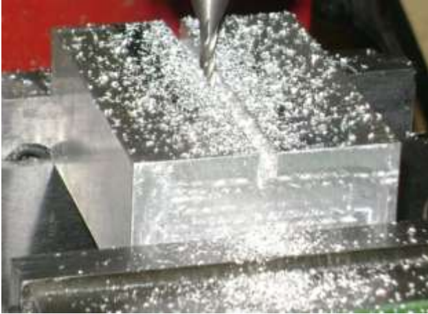
Pengefraisan alur tegak lurus dengan pisau jari
