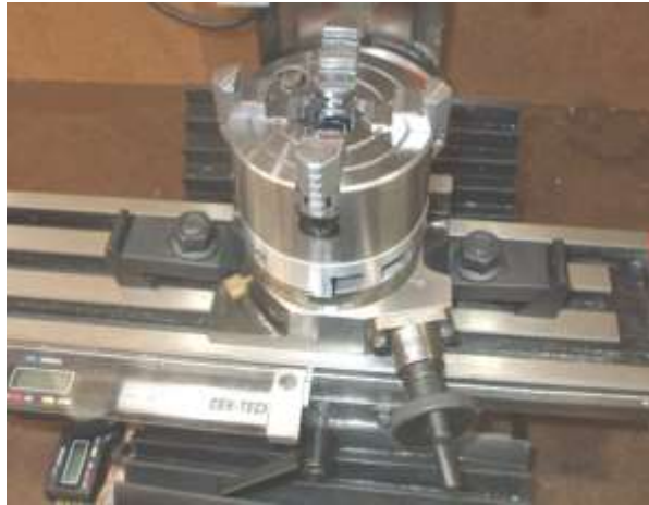
Pemasangan meja putar pada meja mesin
