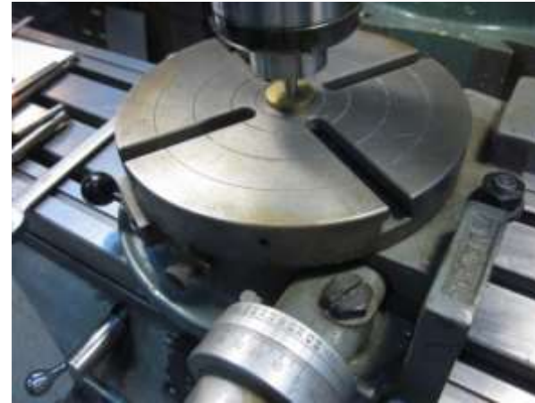
Penyetelan kesepusatan dengan alat bantu pengarah
