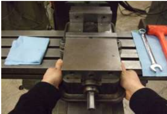
Pemasangan ragum pada meja mesin
