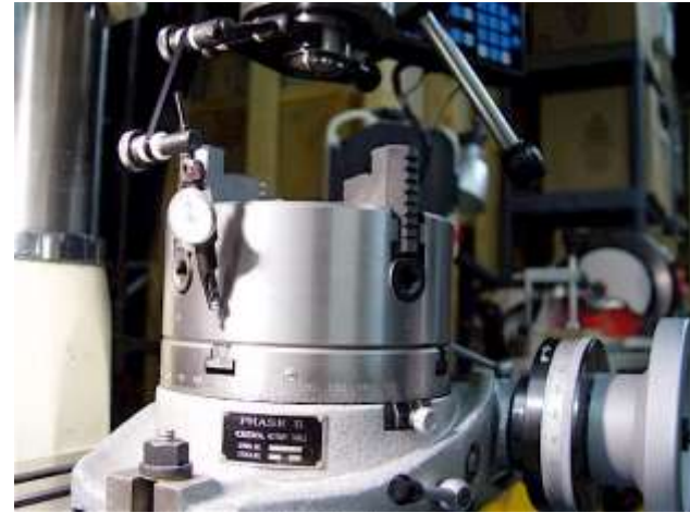
Pengecekan kesepusatan sumbu meja putar dengan dial indicator atau pupitas
