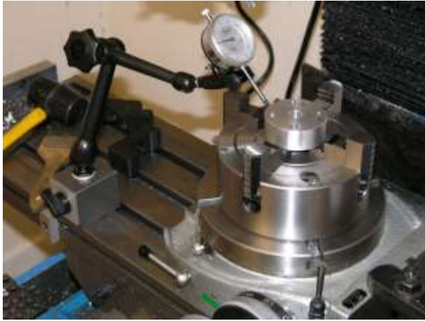
Pengecekan kesepusatan sumbu meja putar dengan dial indicator
