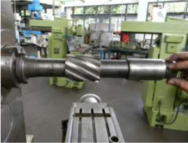
Pemasangan cutter dan ring arbor ( collar )
