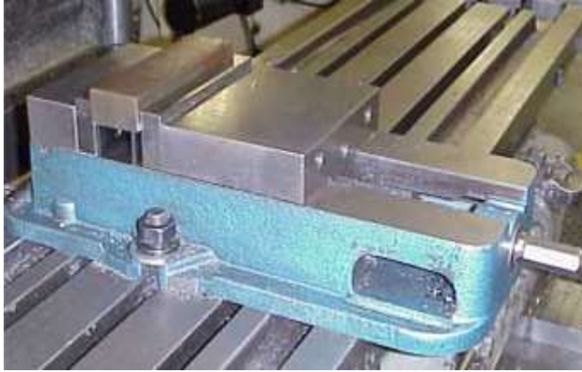
Pemasangan ragum dan benda kerja
