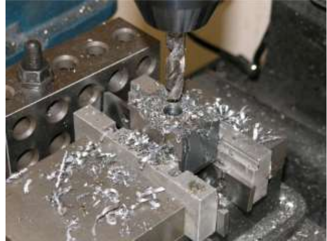
Pembuatan lubang bor sebelum memperbesar lubang
